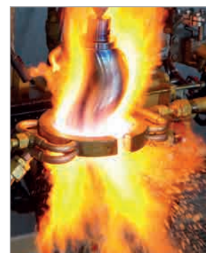
Ротор в процессе термообработки
